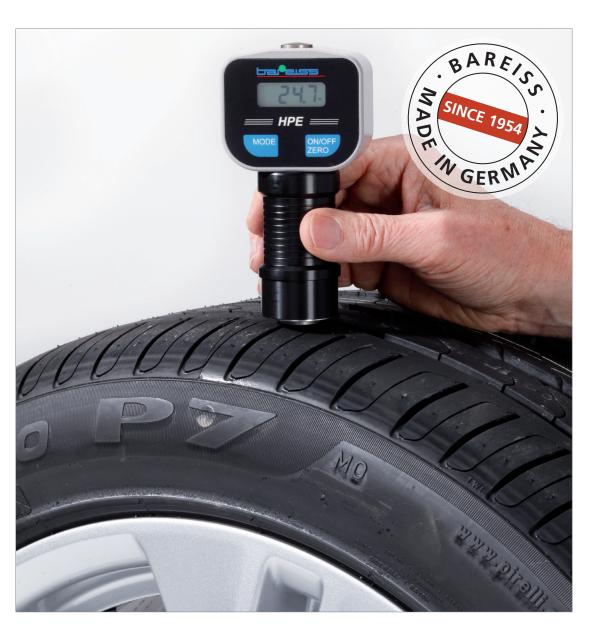
Konstanter Anpressdruck und Messzeit nach Norm, optisches und akustisches Signal, serielle Schnittstelle und PC-Kabel.
